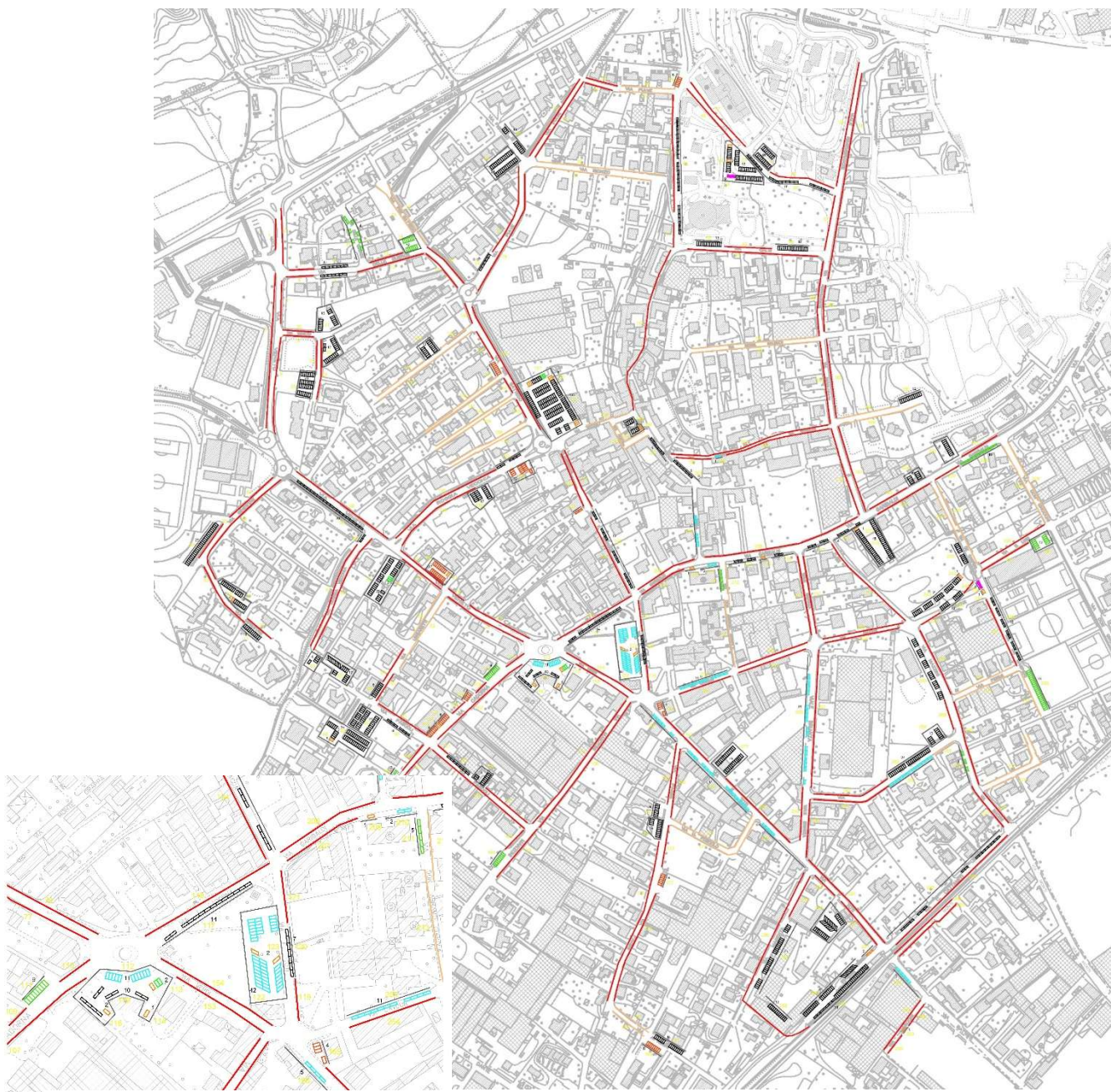
Figura 5.2.1 - Rilievo della sosta – Rappresentazione grafica dei singoli stalli di sosta offerta – Per tipologia e disposizione
